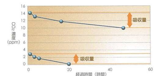
※異なる濃度で2回測定。いずれもCO<sub>2</sub>の吸収効果を確認。アレスシックイ塗装板を5Lテドラバッグにセットし、一定濃度のCO<sub>2</sub>含有空気を封入しCO<sub>2</sub>濃度を測定。
