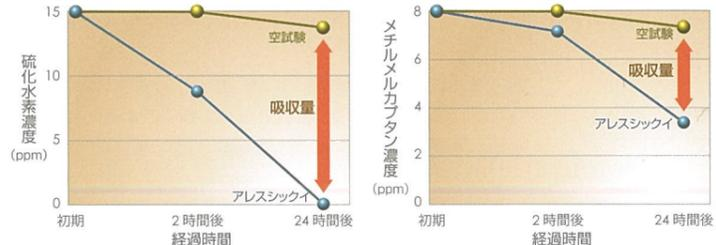
※アレスシックイ塗装板を5Lテドラバッグにセットし、一定濃度の硫化水素又はメチルメルカプタン含有空気を封入し系内の該化合物濃度を測定。
